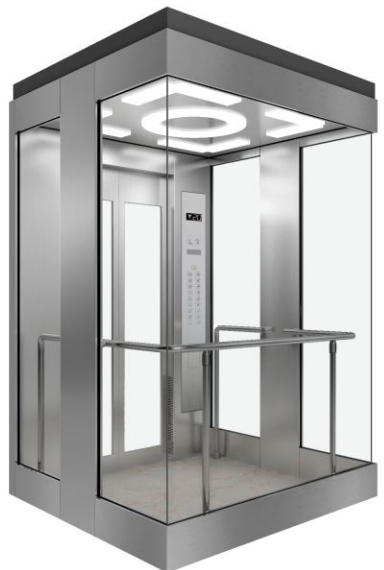
■ XTQ08-691 上下罩：简易上下罩 吊顶：发纹不锈钢 + 亚克力【XTQ04-88】 后壁：夹胶玻璃 侧壁：发纹不锈钢 + 夹胶玻璃 扶手：镜面不锈钢圆管落地扶手【XTQ06-21】 地坪：PVC【XTQ07-31】 推荐前壁：发纹不锈钢
