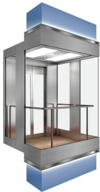
■ XTQ08-1502 上下罩：烤漆钢板（蓝银）+ 发纹不锈钢 + 镜面不锈钢 吊顶：发纹不锈钢 + 亚克力 + LED 筒灯【XTQ04-82】 后壁：发纹不锈钢 + 夹胶玻璃 侧壁：发纹不锈钢 + 夹胶玻璃 扶手：镜面不锈钢圆管落地扶手【XTQ06-221】 地坪：PVC【XTQ07-1307】 推荐前壁：发纹不锈钢
